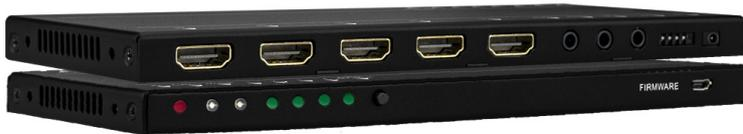
Der ultra flache 4K HDMI Switch UH-4U mit 4 Ports unterstützt 4K UHD Videoauflösungen bis 3840x2160, besitzt einen zusätzlichen Audioausgang und verfügt über eine Audio-de-embedding-Funktion, so dass Sie das Audiosignal aus dem HDMI-Signal „auskoppeln“ und separat wiedergeben können. Zu dem unterstützt dieser 4K HDMI Switch das manuelle und das automatische Umschalten zwischen den einzelnen HDMI-Ports und ist dadurch sehr einfach zu bedienen.
